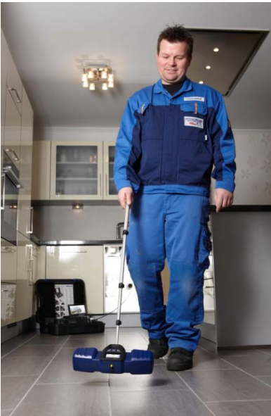
Fig. 32: Localizzazione della testata VIS nel pavimento
