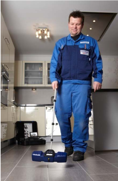
III. 18: Localisation de la tête de caméra dans le sol
